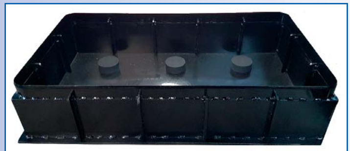
Stanzwerkzeug mit Rahmenverstärkung
